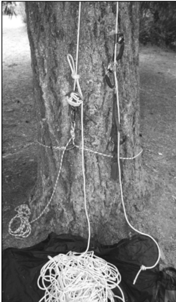
Figura 8d: Descensor 8 de rescate con cuerda 3X
