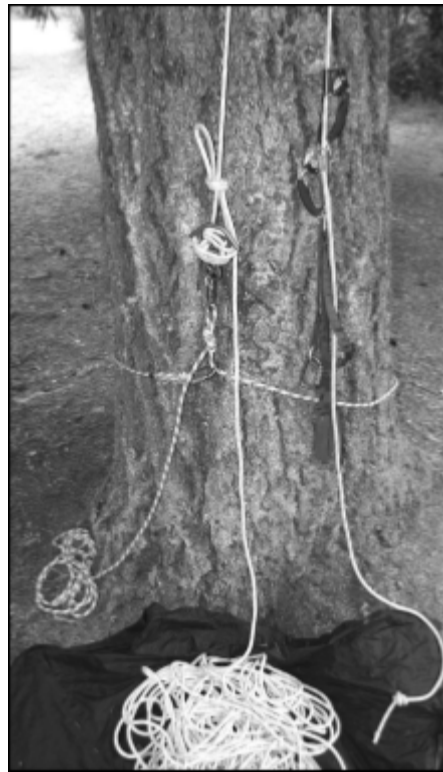
Figura 5e: Descensor 8 de rescate con cuerda 3X
