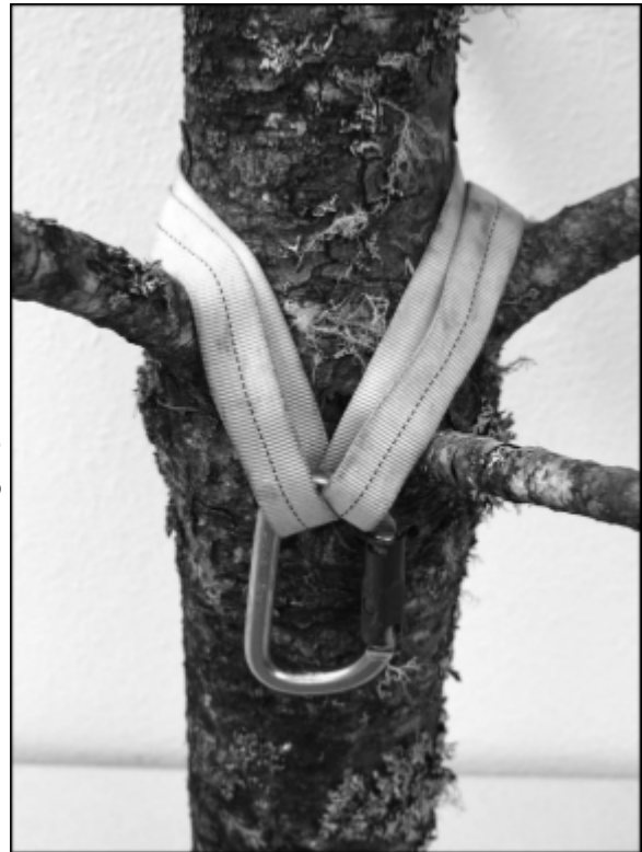
Figura 3d: Nudo de canasta.
