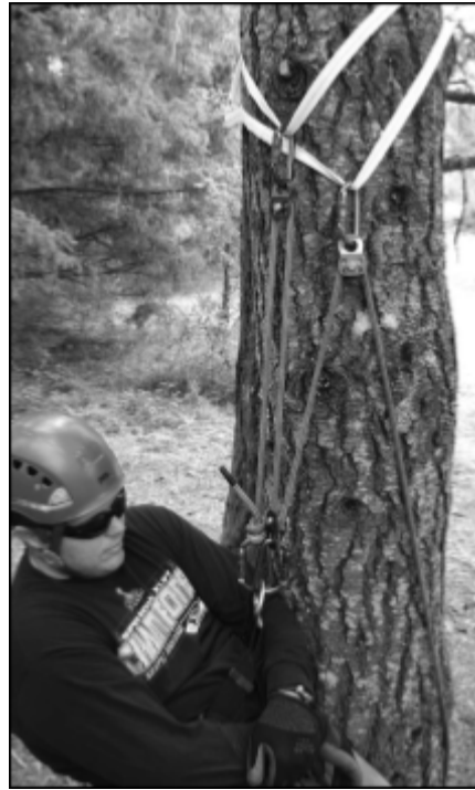
Figura 8c: Sistema de poleas en Z
